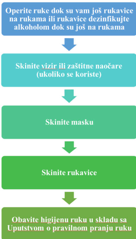
Слика 3 - Редослед скидања средстава и опреме за личну заштиту на раду
